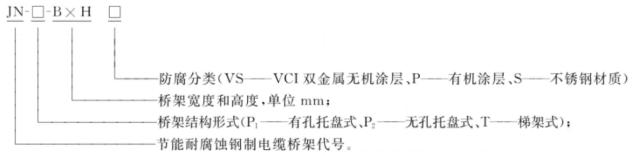
示例:  $JN-P_1-400\times100~VS$  表示宽度为 400~mm、边高为 100~mm 的有孔托盘式、表面防腐处理采用 VCI 双金属无机涂层的节能耐腐蚀钢制电缆桥架。
