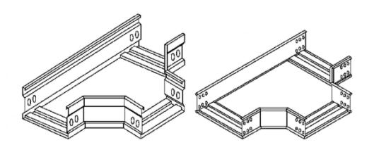
图 3 无孔托盘三通示例
