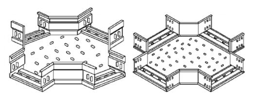
图 8 有孔托盘四通示例
