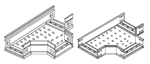
图 7 有孔托盘三通示例
