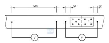
图 F.1 电气连续性试验接线
