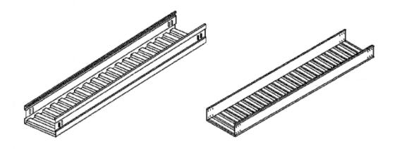
图 1 无孔托盘直通示例
