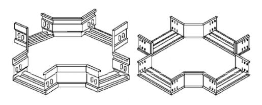
图 4 无孔托盘四通示例
