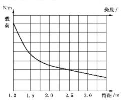
图 D.2 桥架载荷特性曲线图
