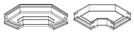
图 2 无孔托盘弯通示例
