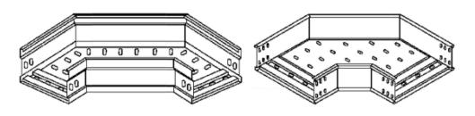
图 6 有孔托盘弯通示例
